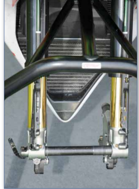
I perni ruota applicati alle forcelle delle moto da competizione hanno diametro elevato, essendo parte strutturale della forcella. Inserire il "mass damper" non rappresenta dunque una modifica radicale.
