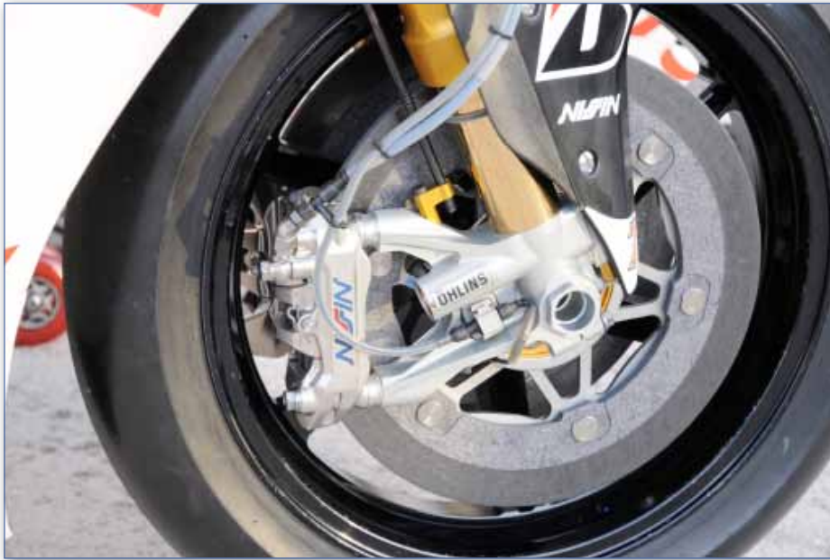
I perni ruota applicati alle forcelle delle moto da competizione hanno diametro elevato, essendo parte strutturale della forcella. Inserire il "mass damper" non rappresenta dunque una modifica radicale.
