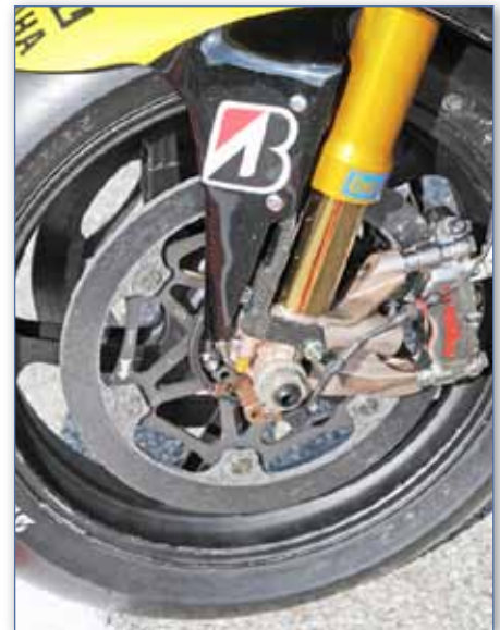
I perni ruota applicati alle forcelle delle moto da competizione hanno diametro elevato, essendo parte strutturale della forcella. Inserire il "mass damper" non rappresenta dunque una modifica radicale.
